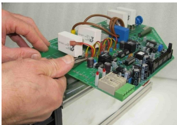
Figura 10-10 Ensamblaje de IGBT de 25 A: desconexión de los cables de las puertas y emisores
