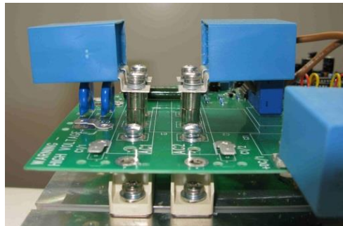
Figura 10-22 Ensamblaje de IGBT de 25 A: Condensadores de Epcos montados sobre módulos diodo.
