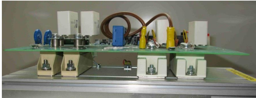
Figura 10-21 Ensamblaje de IGBT de 25 A: coloque los condensadores amortiguadores
