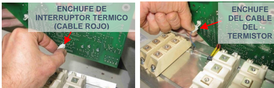
Figura 10-19 Ensamblaje de IGBT de 25 A: reconexión de los enchufes para el interruptor térmico y termistor.
