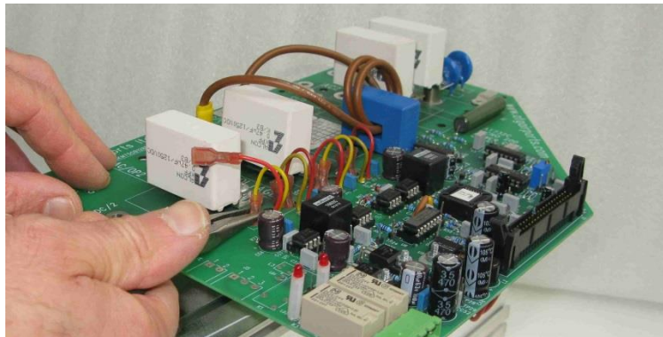
Figura 10-24 Ensamblaje de IGBT de 25 A: reconexión de los cables de las puertas y emisores
