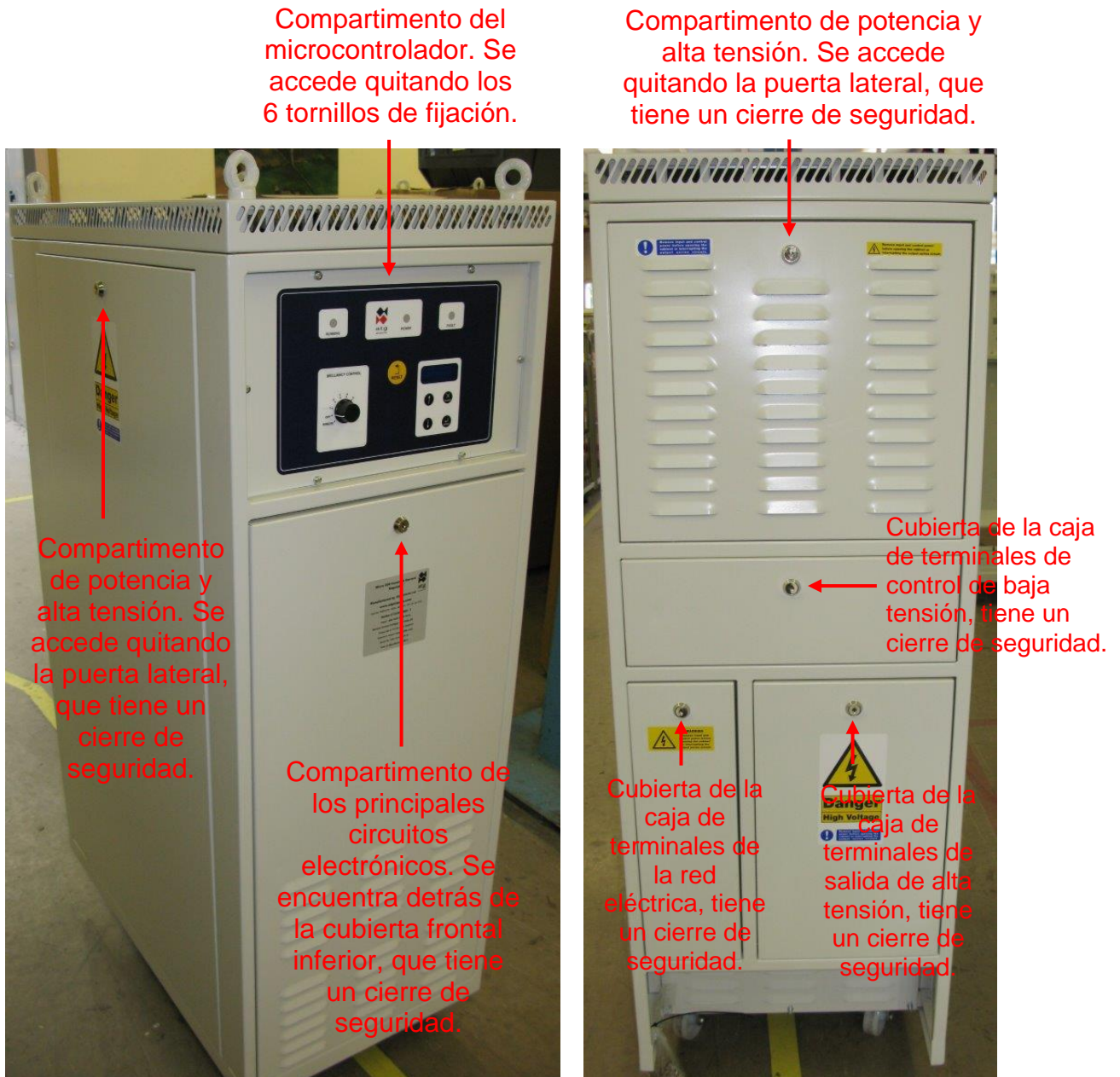
Figura 2-4 Vista lateral / frontal del RCC y vista trasera, donde se aprecian las cubiertas de los terminales
