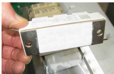
Figura 10-17 IGBT de ensamble de 25 A: untar compuesto disipador de calor en la superficie posterior
