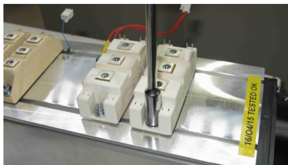
Figura 10-16 Ensamblaje de IGBT de 25 A: desatornille el módulo IGBT o diodo defectuoso
