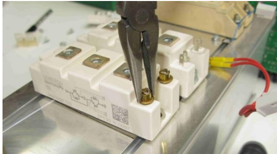
Figura 10-18 Ensamblaje de IGBT de 25 A: retire los anillos de cortocircuito de la puerta / emisor del nuevo IGBT
