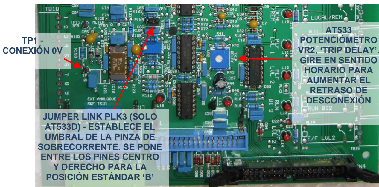
Figura 9-6 Ubicación del potenciómetro 'TRIP DELAY' VR2 y jumper PLK3
